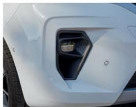
Projecteurs anti-brouillard avant à LED avec technologie Cornering light<sup>[1]</sup>
